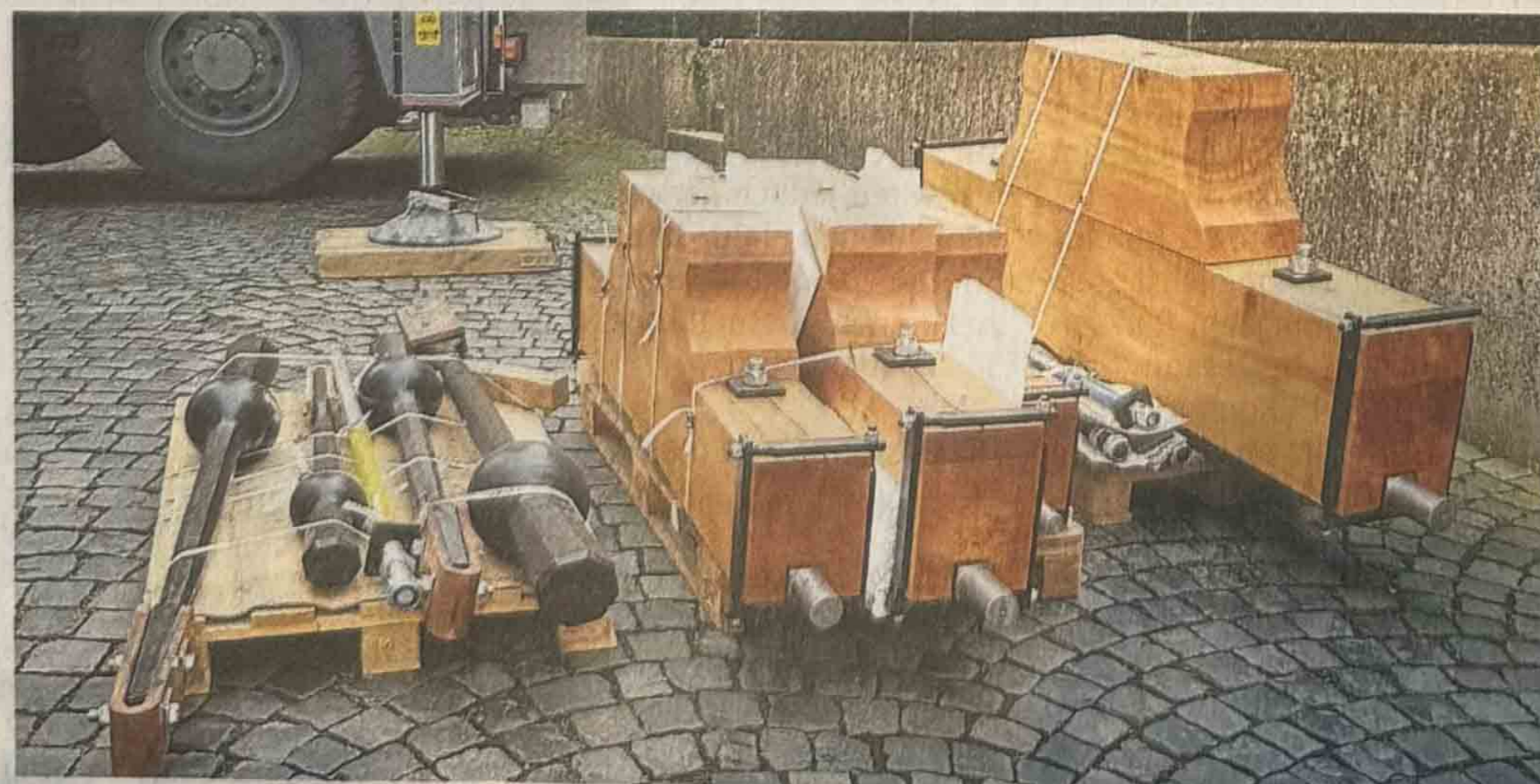
Holzjoche und Stahlklöppel mit Lederbezug liegen bereit. Bei den Jochen ist es wichtig, dass altes Holz eingesetzt wird, das seine Form höchstens nur noch geringfügig verändert.
